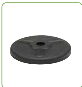
Réf. R0055 - Page R54 Ø 110 • Gomme avec renfort en acier • Charge maxi 6000 N.
