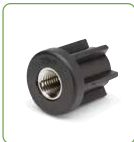
Réf. R0180 - Page R56 Pour tubes ronds de Ø 26,9- 30-33,7-38-42,4-48,3-54- 60,3 mm et 1,5"- 2."
