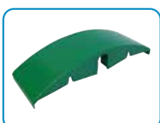
Réf. S0153 - Page S029 Patin tendeur de chaîne. Montage par encliquetage.
